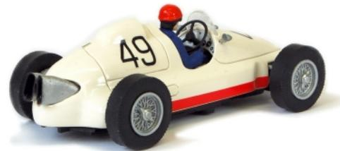
Do ejektorů ústily výfuky vzduchem chlazeného motoru T603, vzniklý "tah" ušetřil výkon ventilátorů
